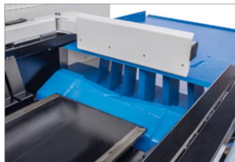
Hydraulische Schichthöheneinstellung 8 bis 14cm
